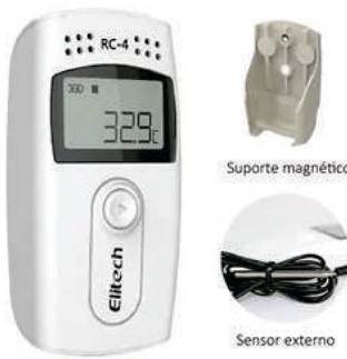
O registrador de dados de temperatura RC-4 possui um indicador de alarme multifuncional LCD, bateria substituível, possui alarme sonoro. Com o registrador de temperatura RC-4 os usuários podem exportar dados em PDF ou Excel através do software de gerenciamento de dados Elitech. O RC-4 é uma alternativa melhor para o monitoramento em indústria farmacêutica, alimentos, armários médicos, laboratórios, armazenamento a frio ou criação de animais.
