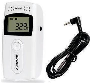
O data logger multiuso RC-4HC é utilizado para registrar TEMPERATURA e UMIDADE de produtos farmacêuticos, médicos, alimentícios, aplicações em laboratórios e armazenamentos na cadeia do frio. Possuem indicador de alarme LCD multifuncional, podendo visualizar temperatura real, data, hora, número de leituras, temperatura máxima e mínima, alarme de temperatura máxima e mínima. Possui bateria substituível e alarme
